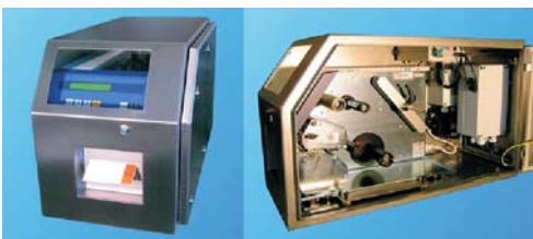
Standard-Labelprinter für die Ex-Zone 1 mit Gönheimer FS850S Steuereinheit. PID-geregelte Spülgaszufuhr zur Kompensation der schwankenden Leckverluste am Papieraustritt.
