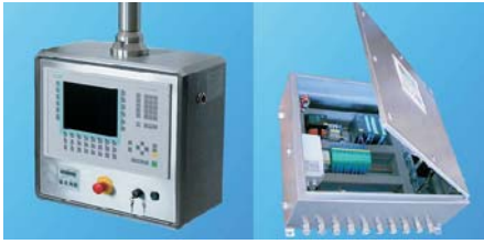
SIMATIC-HMI-Panels und Steuerschränke für die Ex-Zone 1 mit Gönnheimer FS850S Steuer-einheit. Regelung des Gehäuseinnendrucks während Spül- und Betriebsphase zum Schutz der Frontfolien und Tastaturen.
