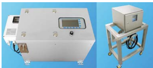
Mess- und Analysegeräte für die Ex-Zone 1 mit Stickstoffspülung. PID-Regelung des Gehäuseinnendrucks sowie integrierendes Spülvfahren zur Minimierung des Spülgasverbrauchs.
