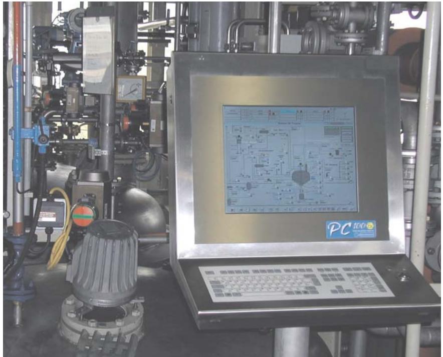
Abb. 1: Unterschiedliche Zündschutzarten – im Idealfall eine Kombination mehrerer Zündschutzarten – machen den Einsatz von Standard-Hardware im Ex-Bereich möglich.
