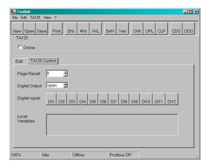
Weiterhin werden die aktuellen Tastendrücke am KB125 auf der Textlink Oberfläche angezeigt (DI1 ... DI12).
