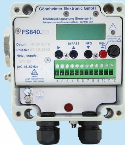
einem überdruckgekapselten Gehäuse (Ex pzc) betrieben wird und dieses Gehäuse, durch ständigen Überdruck mit Luft oder einem Inertgas, vor dem Eindringen explosiver Gasgemische geschützt ist.
