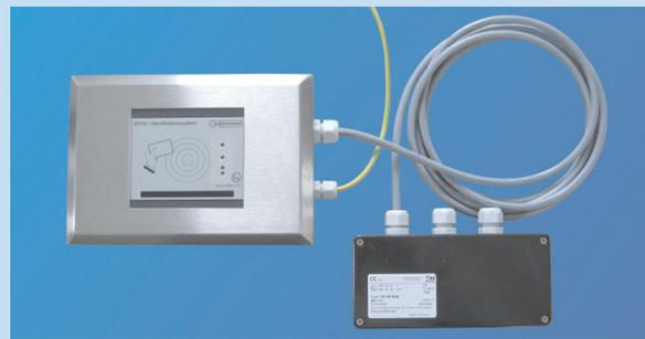
Identifikationssystem ID153 mit Ex e-Klemmkasten
